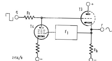
Fig. 5 - Il filtro « passivo »  $F_1$  e gli stadi amplificatori  $A_1$  e  $A_2$  (fig. 2a) formano insieme un filtro attivo con terminale di entrata  $q$  e terminale di uscita  $r$ . La componente fondamentale della tensione rettangolare in  $q$  è trasmessa. Le armoniche superiori sono considerevolmente attenuate, grazie all'alto guadagno di  $A_2$ .
