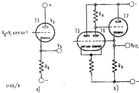
Fig. 3 - a) Stadio semplice a carico catodico (come  $T_3$  in fig. 2 b); triodo  $T_3$  con resistenza di catodo  $R_k$ .
