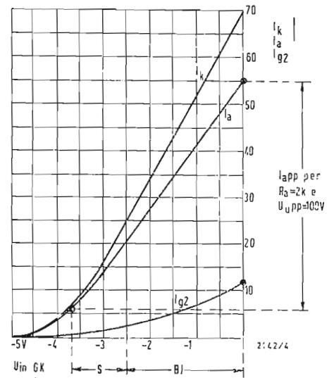
Fig. 4 - Influenza della reazione sull'andamento delle curve caratteristiche della fig. 3 ( $R_a = 2\ k\Omega$ ,  $R_k = 15\ \Omega$ ).
