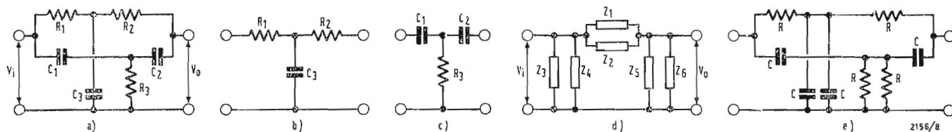
Fig. 4 - a) Filtro a doppio T formato da resistenze e da condensatori. b) e c) Le due sezioni a T, delle quali è formato a). d) Le due sezioni a T di a) sono trasformate in sezioni a  $\pi$ . e) Nel caso di simmetria, la rete a) può essere formata da quattro resistenze identiche R e di quattro condensatori identici C.
