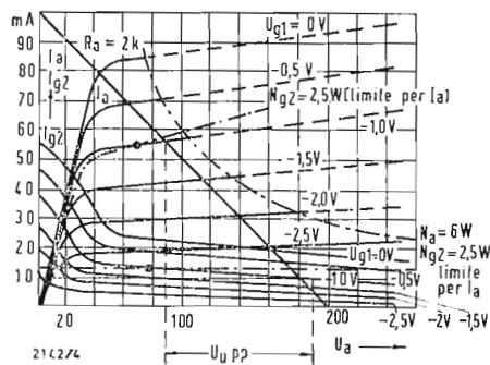
Fig. 2 - Curva caratteristica  $I_a (U_a)$  del tubo PCL200 per  $U_g = U_{gg} = 200$  V. Sono registrati i limiti dati  $N_{a\ max} = 6$  W ed  $N_{g2\ max} = 2,5$  W per la corrente anodica e di griglia schermo, come pure la retta per  $R_a = 2$  kΩ.
