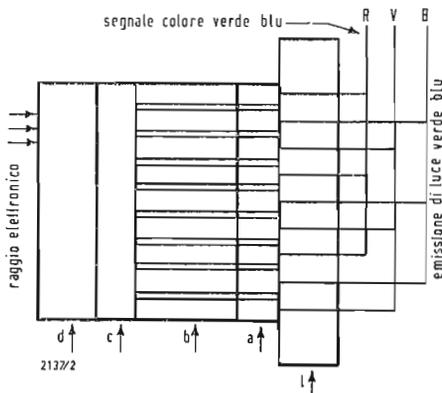
Fig. 1 - Schermo di quadro con tessuto elettrofotoluminescente.
