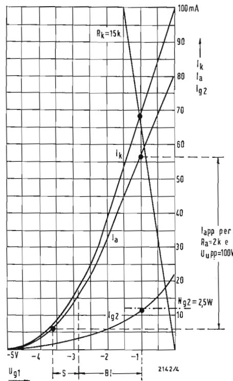
Fig. 3 - Dipendenza delle correnti anodica, catodica e di griglia schermo dalla tensione di griglia in mancanza di pilotaggio per  $U_a = U_{g2} = 200\ V$  e  $R_a = 2\ k\Omega$ .
